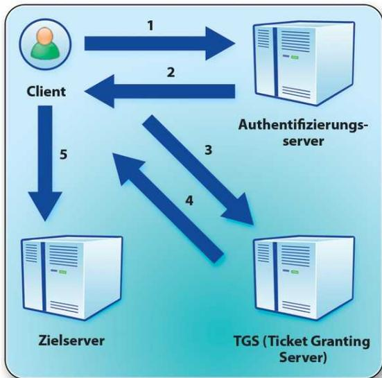
Auch dieses Protokoll erlaubt eine gegenseitige Authentifizierung zwischen dem Server und dem Client. Die Option PKINIT dient der Authentifizierung über ein digitales Zertifikat, das im Kartenspeicher abgelegt wird. Im Rahmen des gesicherten Austauschs von Meldungen bei einer Authentifizierung führt der Anwender die Signierung mithilfe seines privaten Schlüssels aus. Der Schlüssel liegt ebenfalls im geschützten Kartenspeicher.
